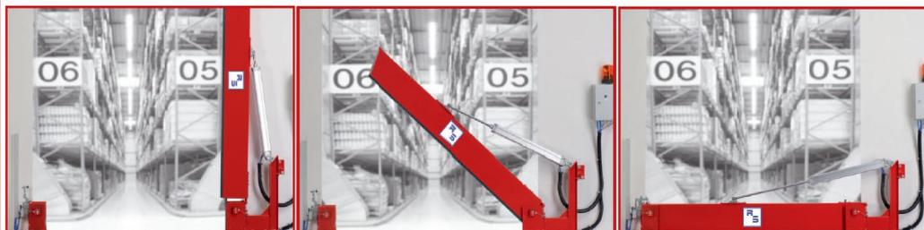
Das automatische Löschwasserrückhaltesystem GDZ-A/PN kann manuell, per Knopfdruck (Totmannschalter) oder vollautomatisch (Brandmeldezentrale) aktiviert werden. Der Schließvorgang wird durch Lichtschranken überwacht um sicherzustellen, dass Personen im Schließbereich der Barriere nicht zu Schaden kommen. Hat die Barriere ihre Endstellung
